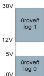
Obr. 4.1) Logické úrovně vstupního signálu
